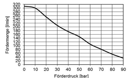
Förderpumpe (KF = Kolbenfläche)
