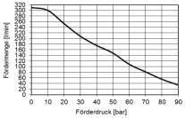
Förderpumpe (KF = Kolbenfläche)
